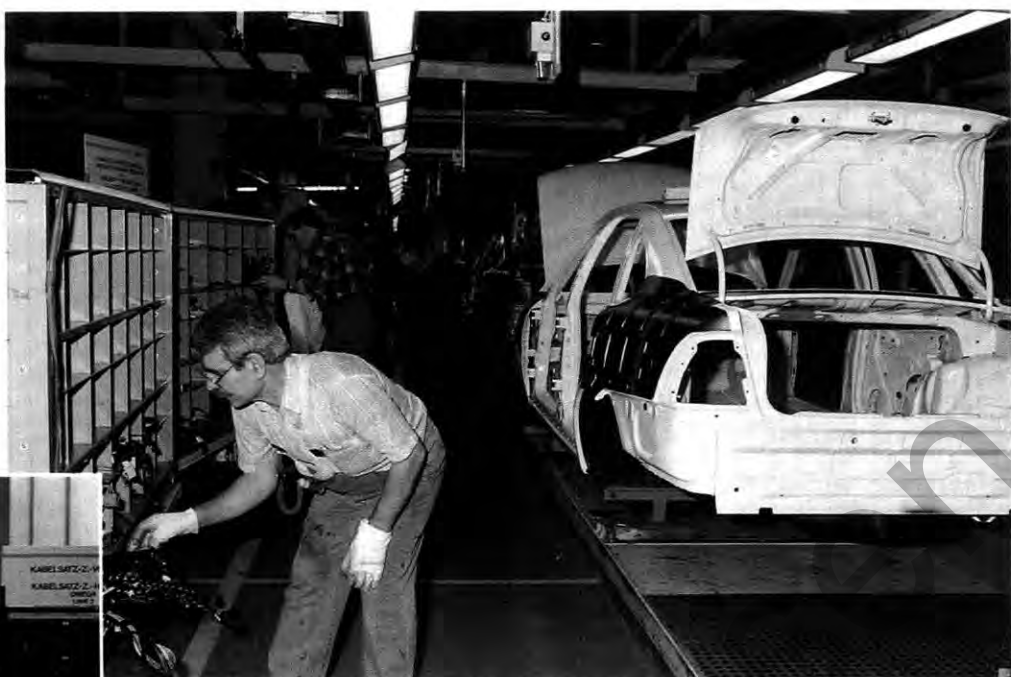
Da gibt's kein Vertun: Die Kabelsätze werden bedarfsgerecht an die Linie gebracht
