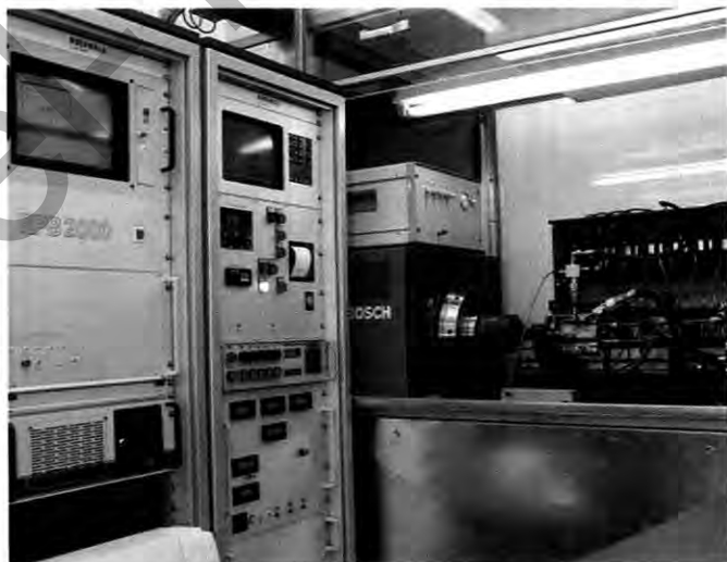
Apparatemedizin für Diesel: Moderne Einspritzpumpen-Prüfgeräte
