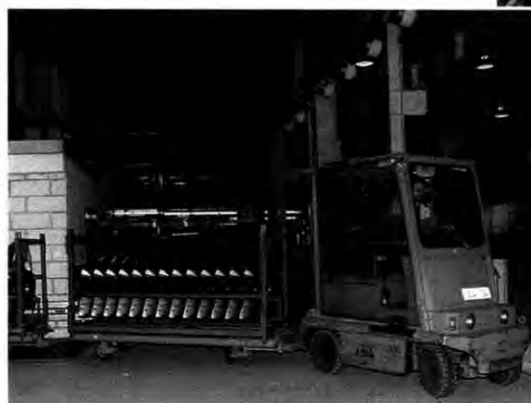
Verschleppt: Ein voller Wagenzug fährt auf Knopfdruck vor und wird vom herbeigefunkten Fahrer abtransportiert
