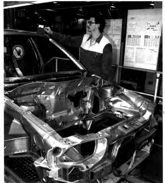
Hütchenspiel: Die farbigen Kappen signalisieren einen Fehler
