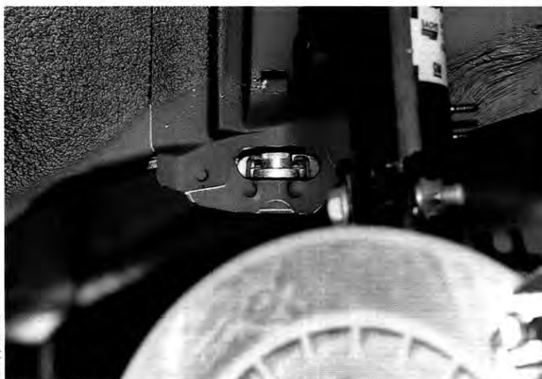
Tolerant: Das patentierte System verfügt über maximal drei Millimeter Spiel
