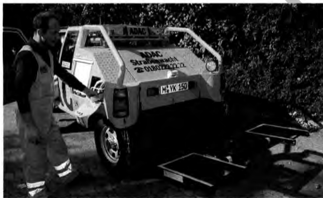
Auf und nieder: Die „Stahlbrille“ trägt alle gängigen Modelle
