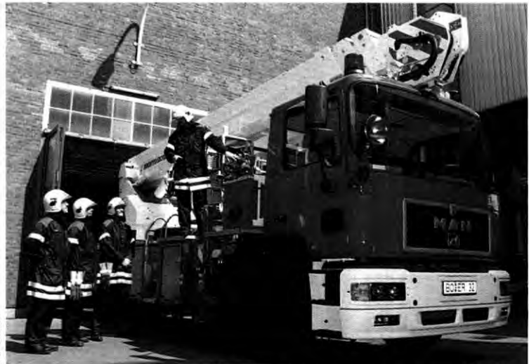
Brandneu: Der Leiterwagen mit seiner 32 Meter-Teleskop-Mastbühne
