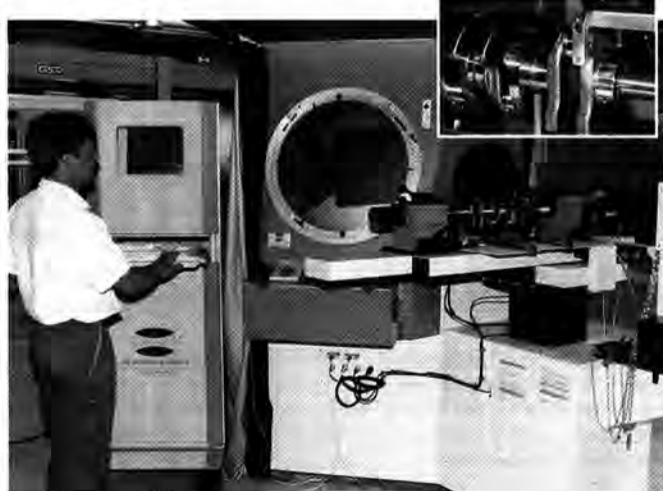
Maß-Nahme: Die Kurbelwellen werden vollautomatisch vermessen
