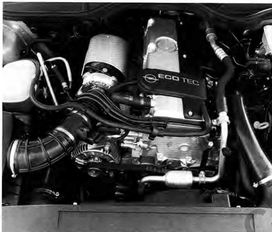
Antrieb: Das neue TDI 16V-Aggregat mit 100 PS erweitert das Motorenangebot im Omega
