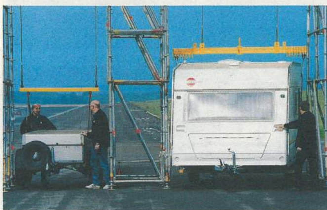
Rohe Kräfte: Charakteristisches Schlingern im Pendelversuch
