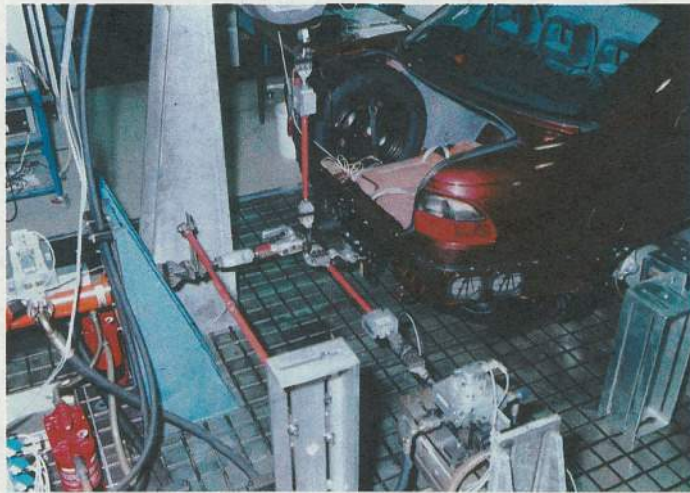
Kraftakt: Auf dem Prüfstand werden horizontale und vertikale Belastungen gemessen
