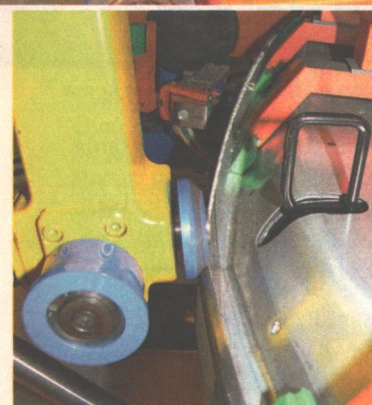
Kopf-Arbeit: Der Keramik-Rollkopf macht den Unterschied
