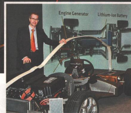
System-Bauweise: Chassis mit Voltec-Technologie
