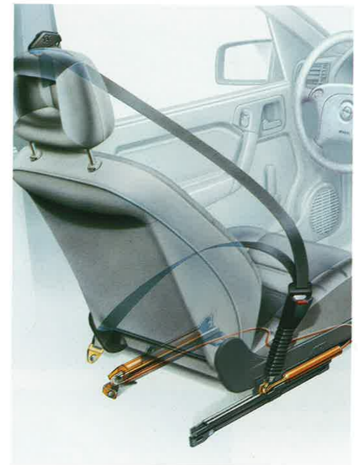
Das Vectra-Aktivgurt-System mit Gurtstraffer, höhenstellbaren 3-Punkt-Sicherheitsgurten vorn und hinten und in die Sitzstruktur integrierten Sitzrampen.
