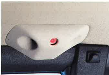
Diebstahlwarnanlage mit Zentralverriegelung.
