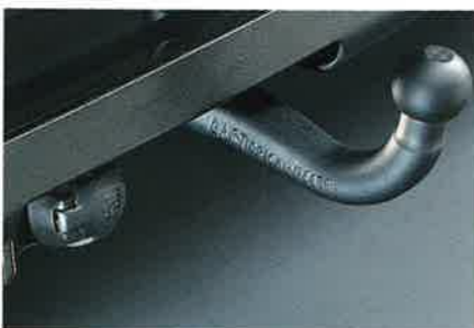
Abnehmbare Anhängerzugvorrichtung, TÜV-Eintrag nicht erforderlich.
