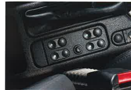
Elektrische Fensterheber mit Tipp-auf-und-ab-Funktion sowie Sicherheitslogik, vorn/vorn und hinten.
