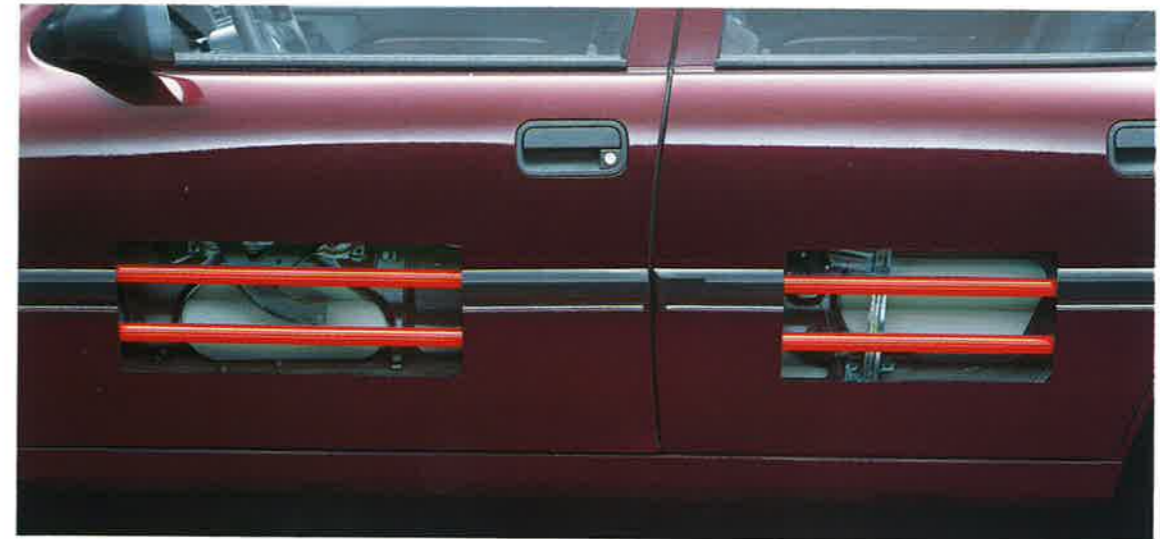
Eine integrierte Doppel-Stahlrohrverstärkung sorgt für Rundumschutz und effektiven Flankenschutz bei seitlichen Kollisionen.
