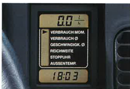
Bordcomputer mit allen wichtigen Funktionen wie z. B. durchschnittlichem Verbrauch seit Fahrtantritt, Reichweite, Außentemperatur oder Uhrzeit.
