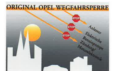
Die elektronische Wegfahrsperrung unterbricht mindestens drei der zum Fahren notwendigen Stromkreise von Zündung, Anlasser, Motorelektronik und elektrischer Benzinpumpe. Das System ist in Deutschland versicherungsrechtlich als Diebstahlschutz anerkannt. Nicht lieferbar bei Diesel- und Turbodieselmotoren.
