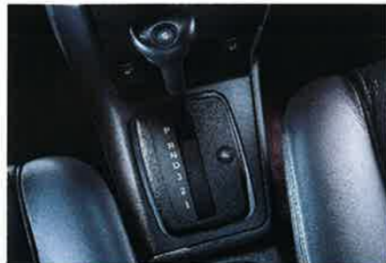
Vollelektronische 4-Gang-Automatik mit den Programmen „Power“, „Economy“, „Winter“.
