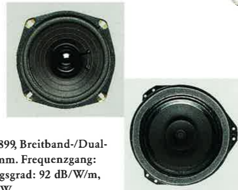
Hecklautsprecher, 1780 901, Breitband-/Dual-Cone-System. Ø: 130 mm, Frequenzgang: 70–21.000 Hz, Wirkungsgrad: 92 dB/W/m, max. Belastbarkeit: 40 W. (Vectra Fließheck).
