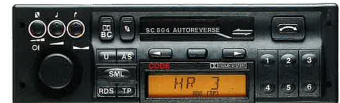
Autoradio- und Cassettengerät SC 804, 1780 312, PLL-Synthesizer, Cassettengerät. Komplette Ausstattung von Autostore bis RDS-Senderidentifikation. UKW, MW, LW, KW, 6x6 Stationstasten. Sicherheit durch abnehmbares Bedienteil. Cassettenteil mit Bandsortenumschalter und Programmsuchlauf.
