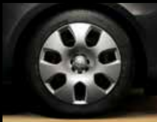
Stahlrad 7 J x 17 inkl. Abdeckung, Reifen 225/50 R 17 (PWP). Serie bei Selection.
