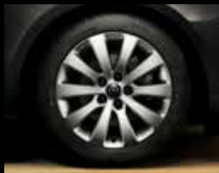
Leichtmetallrad 7 J x 17 im 10-Speichen-Design, Reifen 225/50 R 17 (PGQ). Serie bei INNOVATION, optional für Edition.
