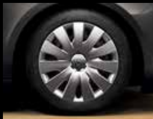
Stahlrad 7 J x 17 inkl. Abdeckung, Reifen 225/50 R 17 (PWP).
