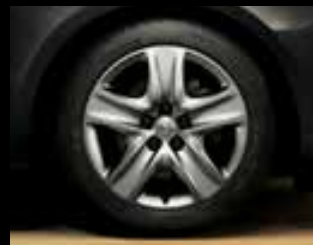
Designrad 7 J x 17 im 5-Speichen-Design, Reifen 225/50 R 17 (PWT). Serie bei Edition.
