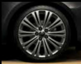
Leichtmetallrad 8 J x 19 im 10-Doppelspeichen-Design, titanfarben, Reifen 235/40 R 19 (PZU). Optional für Edition, Sport und INNOVATION.
