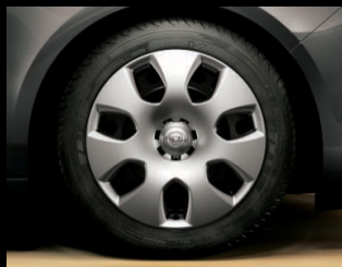
Stahlrad inkl. Abdeckung im „7-Speichen“-Design, 7 J x 17 mit Reifen 225/50 R 17 oder 6 1/2 J x 16 mit Reifen 215/60 R 16 (PWP/PWM).
