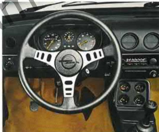
SR-Instrumente (Beifuss). Radio gegen Mehrpreis, Konsole in Verb. mit 1.2 l-S-Motor u. Schaltgetriebe.
