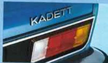
Große, gut erkennbare Heckleuchten. 2 Rückfahrleuchten. Stabile Stoßfänger mit PVC-Schutzleiste.
