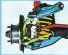
Aufwendige Doppelquerlenker-Vordachse mit Schraubenfedern, Drehstab- Stabilisator, Scheibenbremse und Bremskraftverstärker. Hohe Sicherheit, viel Fahrkomfort.
