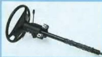
Sicherheitslenkung mit Abreißschlitzen, stoßabsorbierendes Montagerohr mit Faltelement, Teleskopspindel, Direkte, exakte Lenkung, sicheres Fahren.
