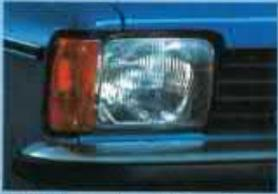
Rechteckscheinwerfer: mehr Sicht, mehr Sicherheit. Integrierte Blinker: gut geschützt, auch von der Seite gut zu sehen.
