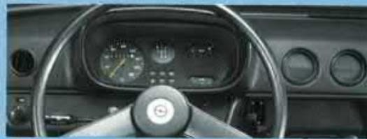
Übersichtliche, blendfreie Instrumentierung, Instrumententafel voll abgedeckt, handliches Sicherheitslenkrad.
