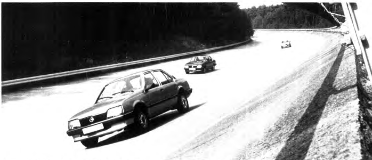
Auf der 5 Kilometer langen Rundfahrbahn, dem „großen Kreis“, der eine absolut gleichförmige Fahrdynamik über eine beliebig lange Strecke und eine beliebig lange Zeit erlaubt, lassen sich Meßergebnisse von äußerster Präzision ermitteln.
