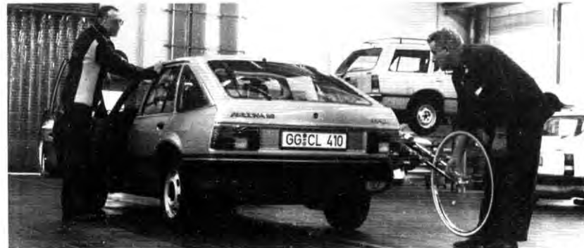
In der Werkstatt des Prüffeldes beim Installieren eines Peiseler-Rades, mit dem die exakte Messung einer Wegstrecke vorgenommen wird.
