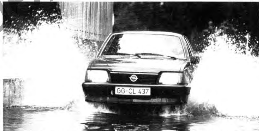
Zu dem umfangreichen speziellen Korrosionstest unter härtesten Bedingungen gehört auch die wiederholte Fahrt durch das Salzwasserbecken mit achtmaliger Salzwasserduche für das Fahrzeug.
