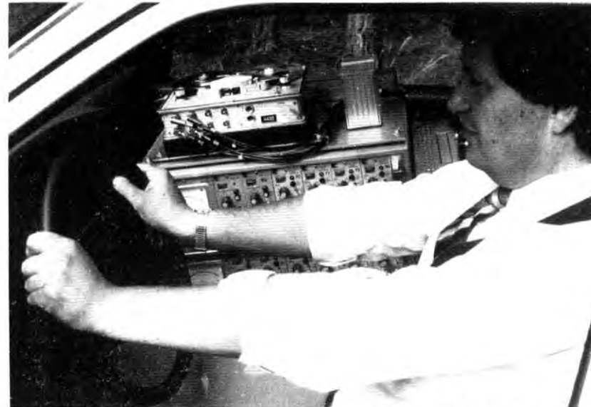
Blick in das Cockpit eines Versuchsfahrzeuges; deutlich sind die Spezialmeßgeräte zu erkennen, mit denen die erforderlichen Daten ermittelt werden.
