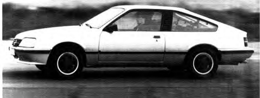
Mit einem Luftwiderstandsbeiwert von c_w 0,35 ist der neue Monza jetzt eines der windschlüpfigsten Automobile überhaupt. Allein die Verbesserung der Aerodynamik bringt Verbrauchseinsparungen um sieben Prozent.
