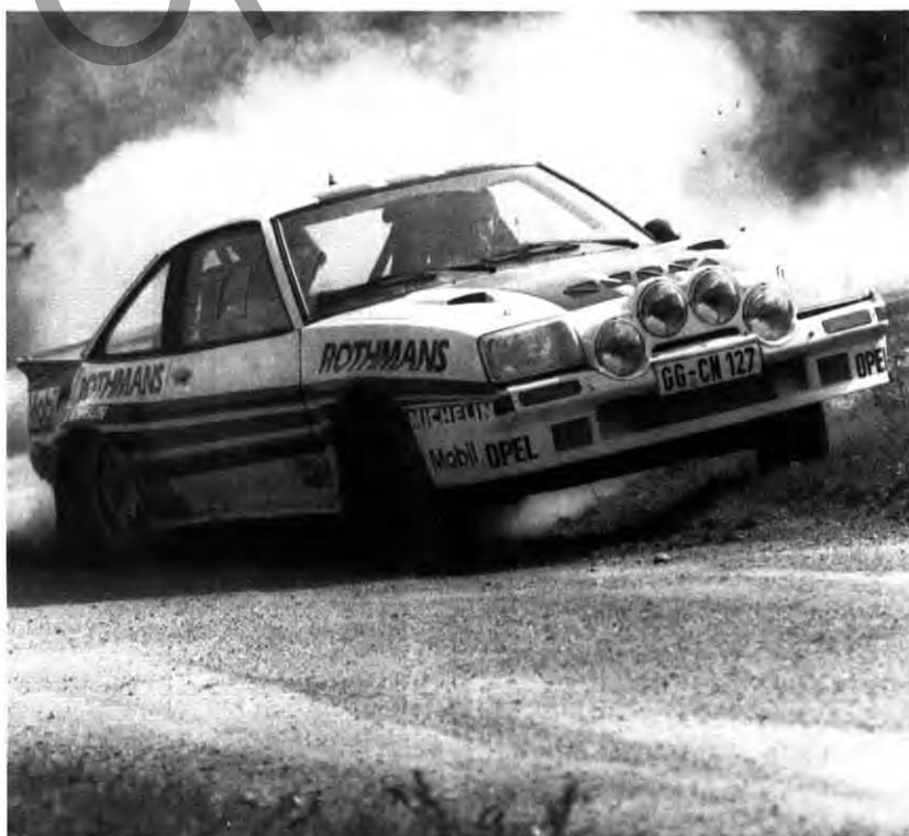
Auf dem Bild die Rallye-Version des Manta 400. Er ist 80 Kilogramm leichter als der Ascona, 15 PS stärker (275 PS) und beschleunigt in 5,5 Sekunden von 0 auf 100 km/h. Sein internationales Debüt gab er bei der Korsika-Rallye Anfang Mai, sein deutsches bei der Metz-Rallye vor wenigen Tagen.
