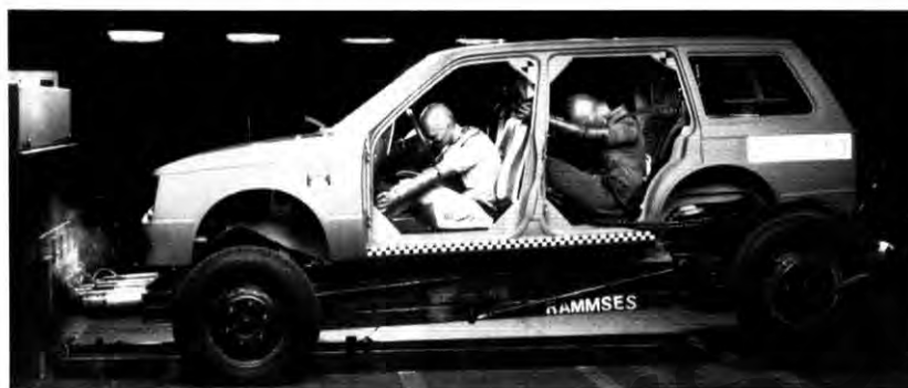
Diese Aufprallsituation im „Rammtest“-Test kann Erkenntnisse zur Verbesserung der Gurtsysteme und des Innenraums vermitteln. Beim „Rammtest“-Test wird ein Fahrzeug auf einer Lafette fest verankert, die dann gegen eine Wand crasht.
