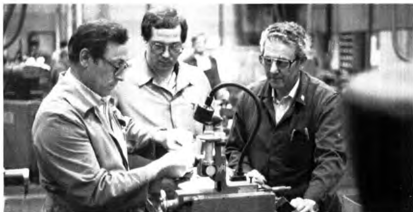
Kolonnenführer Hermann Jung, Meisteranwärter Heinz Maurer und Kontrolleur Hans Bestyak (von links) beim Prüfen von Spiralbohrern mittels Goniermeter.
