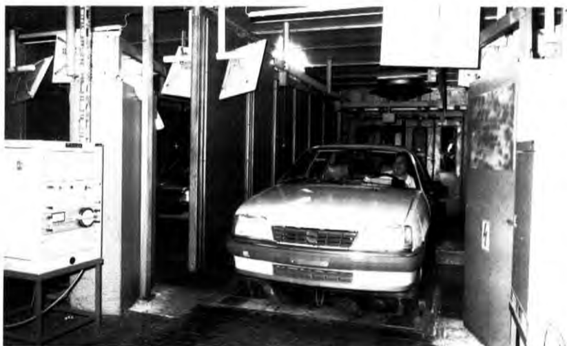
Ein wichtiger Inspektionsschritt nach der Fertigstellung des Fahrzeuges: der Bremsprüfstand der Inspektion mit Mitarbeiter Siegfried Schmidt.
