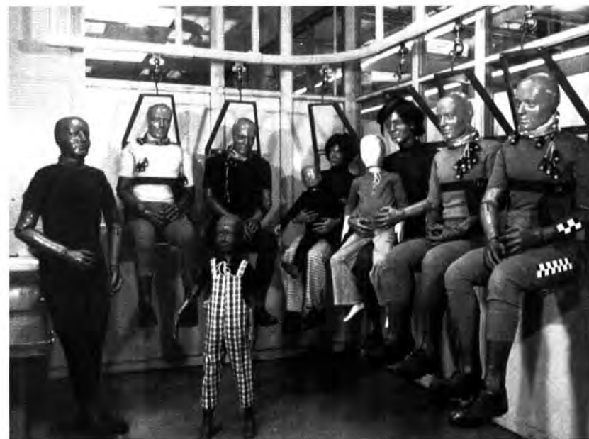
Das „Gruppenbild mit Dame“ zeigt Dummies, die bei uns als Versuchspuppen und Träger von Meßgeräten dienen. Sie liefern bei Crashtests wertvolle Aufschlüsse darüber, welche Verletzungen Passagieren hätten zustoßen können und wie das Verletzungsrisiko künftig weiter zu mindern ist.
