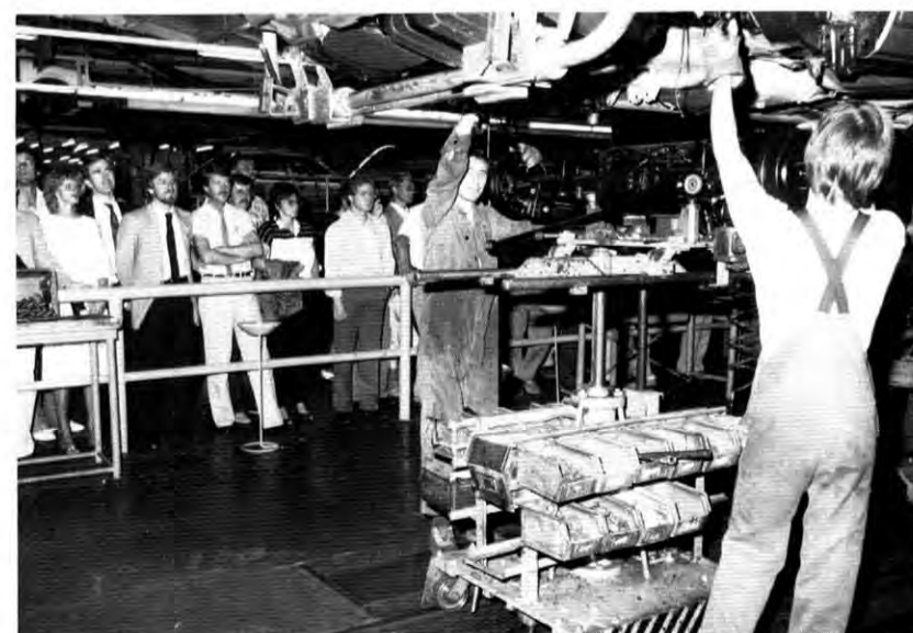
Höhepunkt jeder Werkführung ist die „Hochzeit“ am Endmontageband; gebannt verfolgen die Besucher wie die Karosserie mit Motor sowie Vorder- und Hinterachse vereinigt wird.
