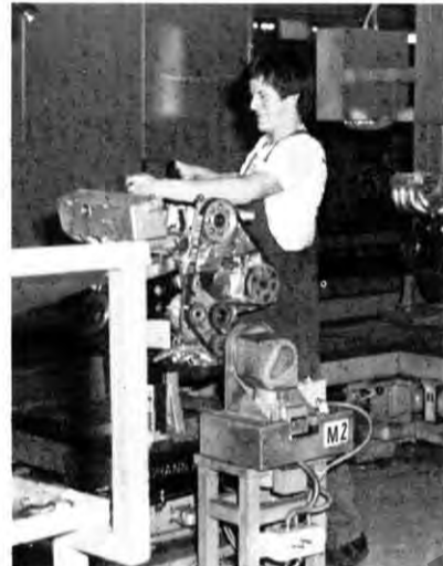
Mitarbeiter G. Gerhard beim Anziehen der Zylinderkopfschrauben.
