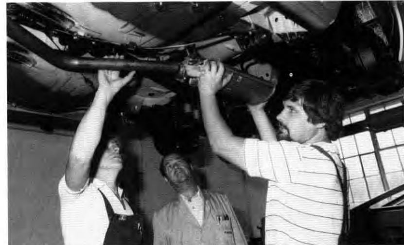
In der Wagenendmontage wird die günstigste Auspuff-Montage „geprobt“. Auf unserem Bild die Mitarbeiter Wolfgang Schneider, Gerhard Hirschen und Obermeister Albert Helfrich.
