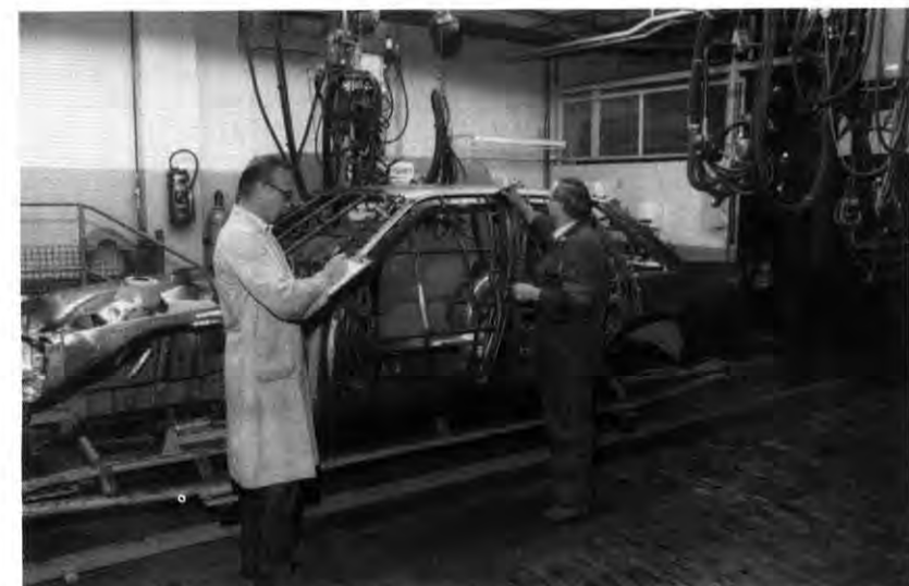
Bei der Überprüfung der Karosserie-Öffnungen mit entsprechenden Öffnungslehren auf dem Bild Meister Adolf Mauler mit Inspektor Lothar Zielke.
