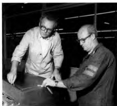
Überprüfung der Passung des Heckraumdeckels durch Obermeister Walter Grimm und Inspektor Erich Spengler.
