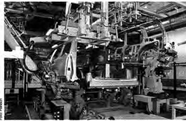
Neu: Roboter entnehmen das Material direkt dem Fördergestell
