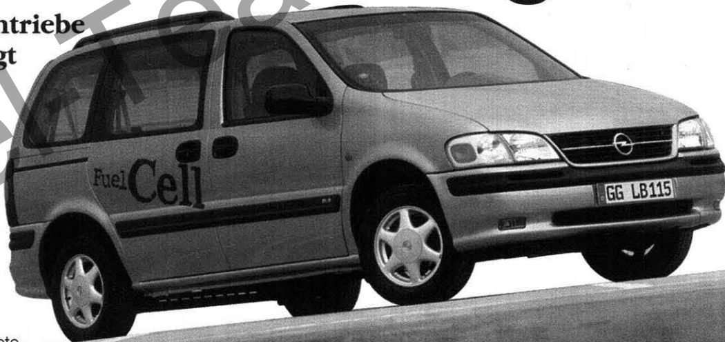
Multitalent: Beim Sintra-Prototyp sind im Bereich der Rücksitze die Methanol- und Wassertanks untergebracht
