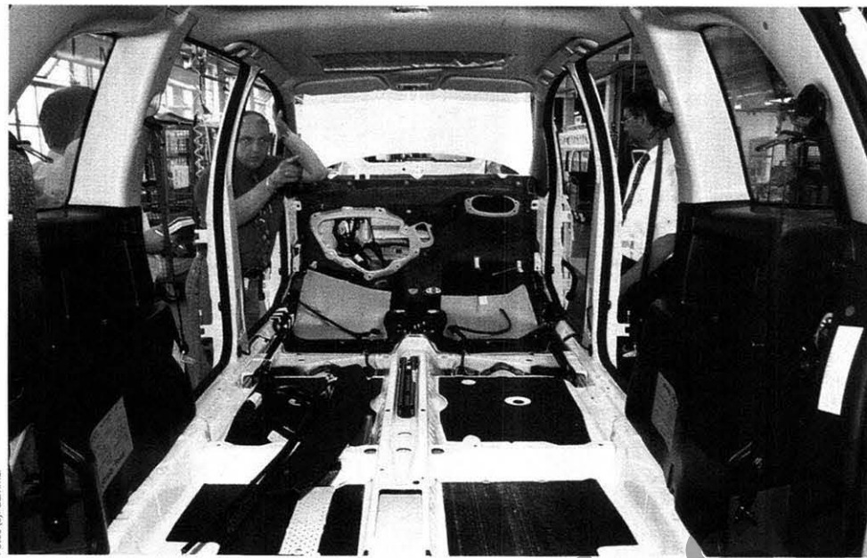
Theorie und Praxis: An der Pilotlinie werden die Fertigungsabläufe für den Zafira optimiert
