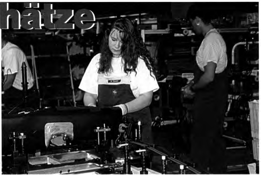
Nahher: Dank „FDS“ werden die Leitungen vormontiert und anschließend automatisch verschraubt
