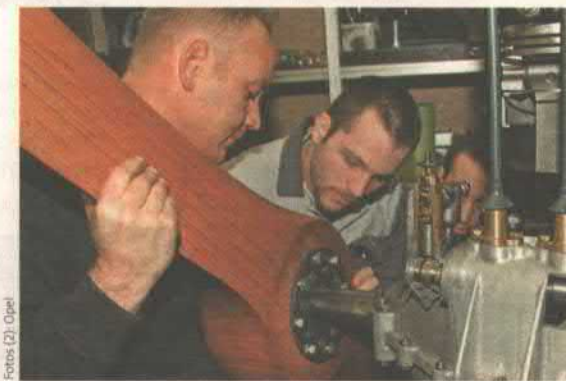
Rotor: Die Montage des hölzernen Propellers
